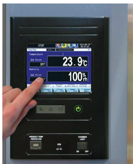
Programmsteuerung P-300, integriert in Prüfschrankschür
