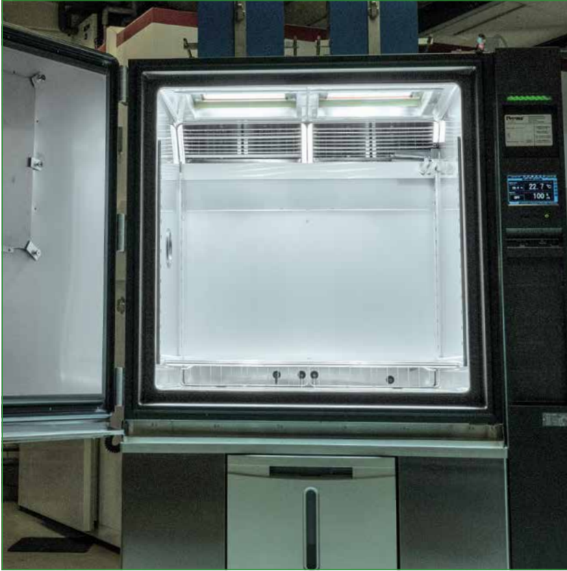
800-Liter Klimaprüfschrank mit Sonnensimulatoren, geeignet für Prüfungen gem. DIN 75220
